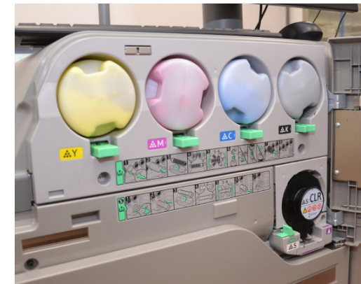
Blick auf die Tonerkartuschen der Ricoh C 7500 samt Sonderfarbe.
