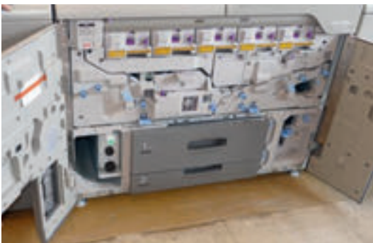
Die fünfte Farbstation der Ricoh Pro C7200x bietet nun die Möglichkeit Value-Added-Printing zu betreiben.
