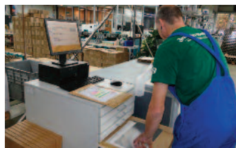
Jeder Drucker bei Bischof kann seinen Job mit den entsprechenden Daten am Terminal aufrufen, das passende Plattenformat wählen, den Belichtungsvorgang starten und die Platte von Hand in den Kodak T400 einführen.
