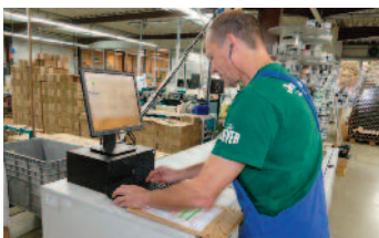
Jeder Drucker bei Bischof kann seinen Job mit den entsprechenden Daten am Terminal aufrufen, das passende Plattenformat wählen, den Belichtungsvorgang starten und die Platte von Hand in den Kodak T400 einführen.
