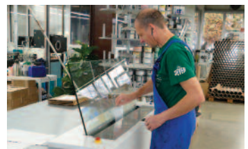
Jeder Drucker bei Bischof kann seinen Job mit den entsprechenden Daten am Terminal aufrufen, das passende Plattenformat wählen, den Belichtungsvorgang starten und die Platte von Hand in den Kodak T400 einführen.
