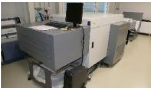
Der Plattenbeliefer Kodak Magnus 400 Quantum von Wesseler aus dem Jahr 2014 ist nach wie vor im steten Einsatz für die Offsetdruckmaschinen.
