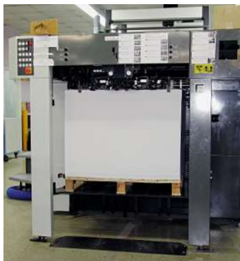
Bis 1.150 mm können am An- und Ausleger gestapelt werden.
